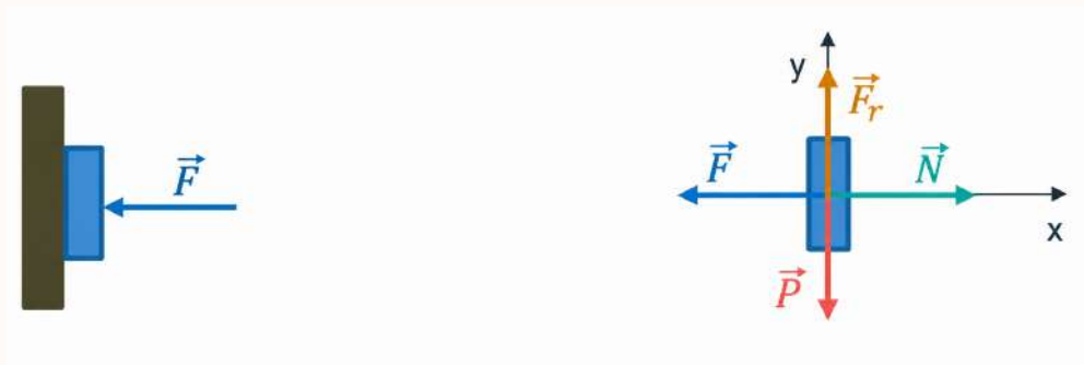
Figura 4.5: Diagrama de cuerpo libre de un libro sostenido contra una pared vertical.
