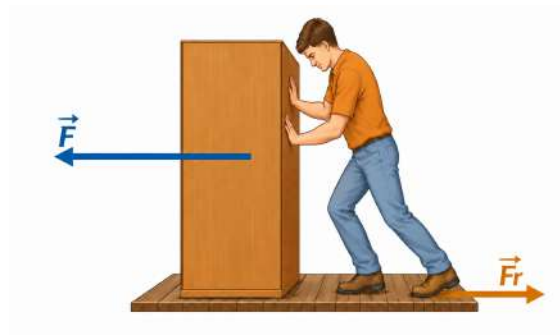
Figura 4.4: Fuerza aplicada y fuerza de rozamiento sobre un cuerpo pesado.
